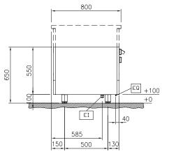
Electrical inlet (power) Equipotential screw
